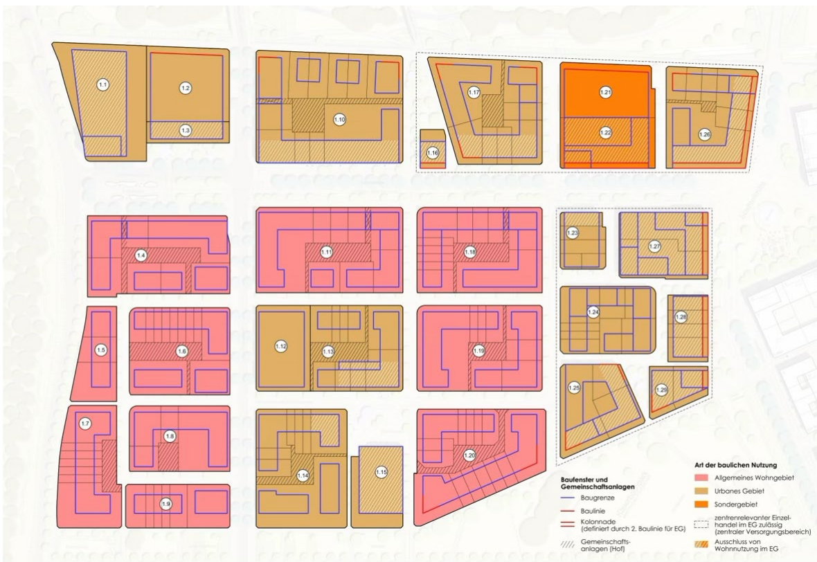
Abb. 20: Vereinfachte Darstellung des Bebauungsplans „Dietenbach – Am Frohnholz“ (Abbildung vergrößert in Anlage 4, Seite 41)
