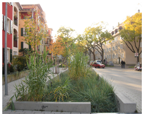
Abb. 101: Sickerbecken als Pflanzbeet mit Sitzgelegenheit Peter-Sprung-Straße (die Holzauflagen wurden leider gestohlen) [1]
