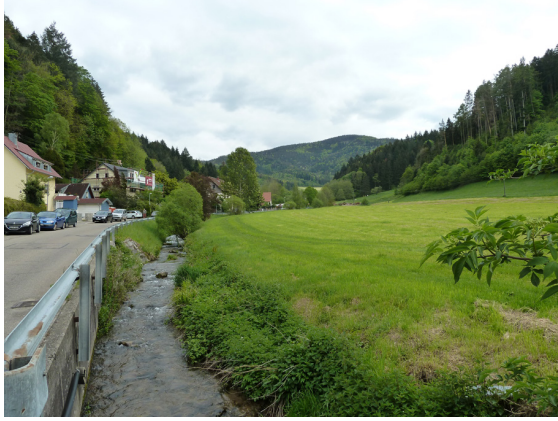
Abb. 127: Reichenbach (Kappel) – Potenzial zur Qualifizierung: Hier könnte dem natürlichen Fließgewässer mehr Raum gegeben werden, indem bepflanzte Uferstreifen und abgesenkte Rückhaltebereiche geschaffen werden. Solche Maßnahmen verbessern den Wasserhaushalt am Ufer, schützen vor Nährstoffeinträgen, sorgen für Beschattung und verzögern den Abfluss zum Schutz der Unterlieger. Der Wasserrechtliche Gewässerrandstreifen von 5 bzw. 10 m ist bei der Bewirtschaftung zu beachten. [3]
