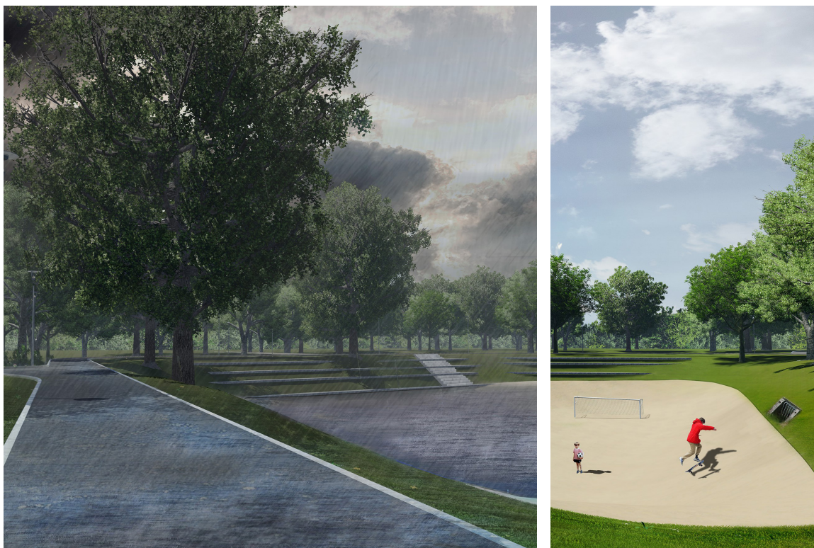
Abb. 82: Beispielhafte Planung einer temporär einstauenden multifunktionalen Fläche für den Rückhalt von Starkregenereignissen (Visualisierung: MUST Städtebau)
