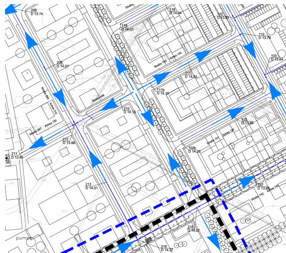
Abb. 175: Notabflusswege in der Ausführungsplanung der Regenwasser-Entwässerung für den 2. Bauabschnitt (Auszug Lageplan Überflutung - Masuch + Olbrisch / ITWH, März 2003)
