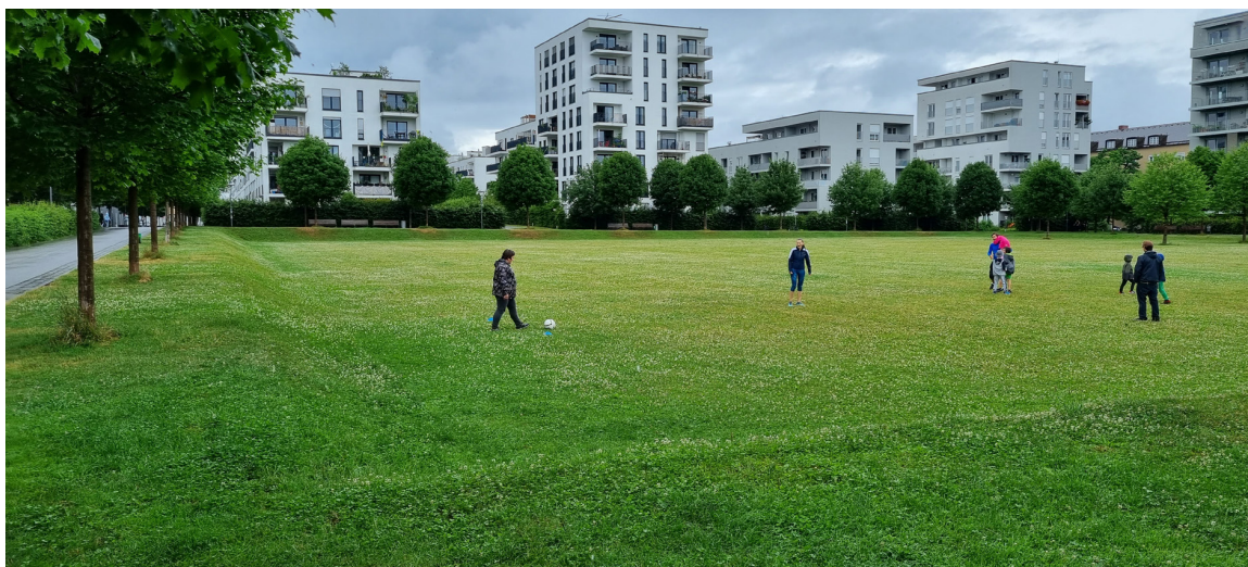
Abb. 86: Als Retentionsfläche für Starkregen abgesenkter Quartierssportplatz in München-Giesing [1]
